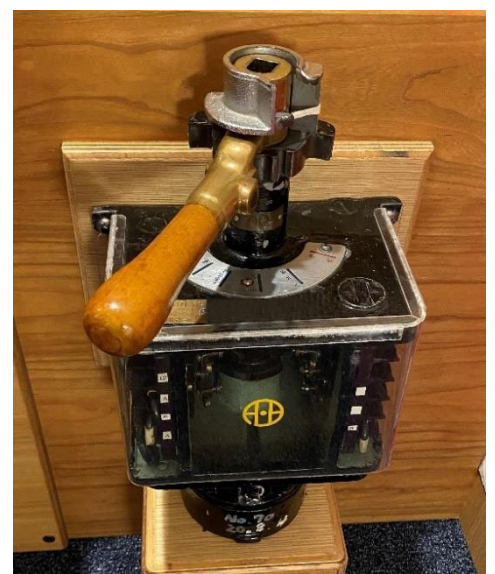
相鉄 7000 系から取り外し設置した ブレーキ弁ハンドル部
